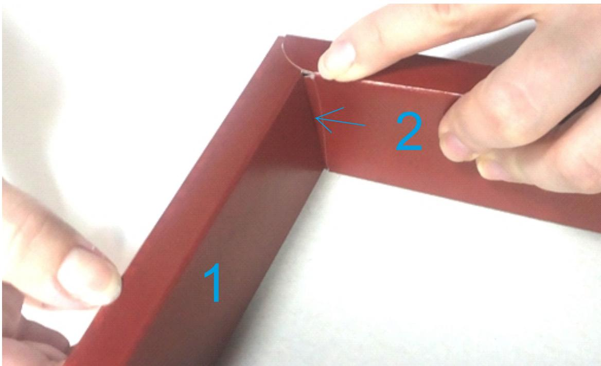
5. После того, как обе стенки 2 установлены, осторожно задвигаем стенки 1 внутрь.
