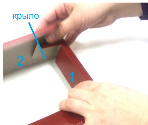
3. Накройте стенкой 2 собранную часть коробки, как показано на рисунке, затем опустите стенку 2 внутрь коробки.
